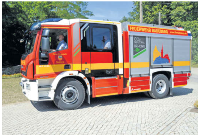
Der HLF10 ist schmäler als andere Fahrzeuge dieser Art und somit in engen Gassen wendiger. Zudem ist es gasbetrieben und kann auch mit Biogas betankt werden.
