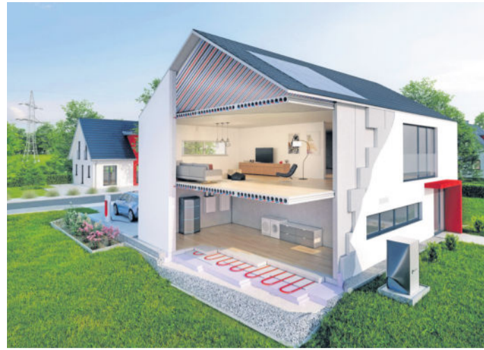
Die Kombination von oberflächennahen, schnell reagierenden Klimadecken und Bauteilaktivierungen ist eine hocheffiziente Möglichkeit zur Speicherung regenerativer Überschussenergie.
