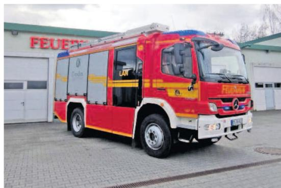
Das Hilfeleistungslöschgruppenfahrzeug 10, kurz HLF 10.
