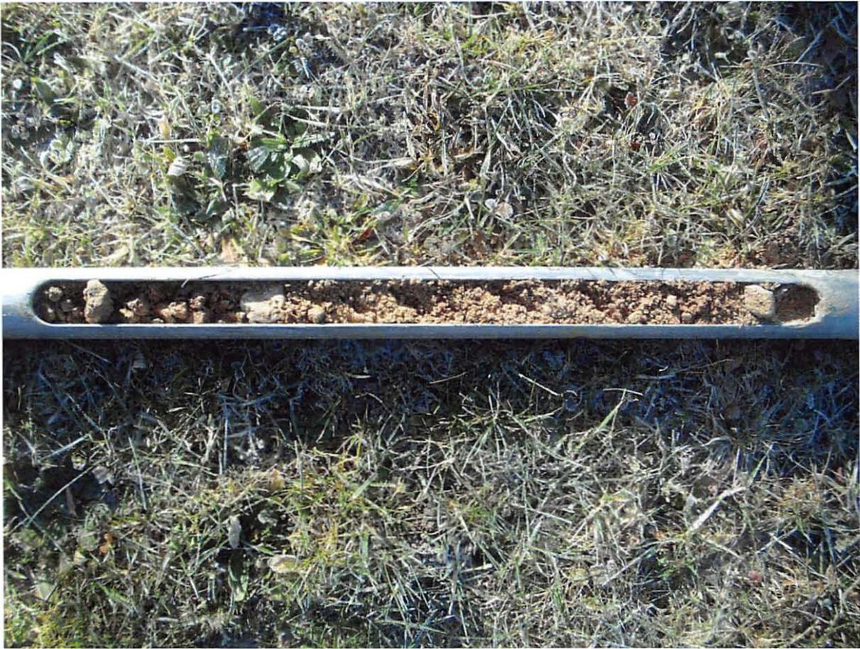
Bild 5: SO-Ecke, Bereich 2,0-2,4 m, Mittelkies unter Mittelsand, stark kiesig.
