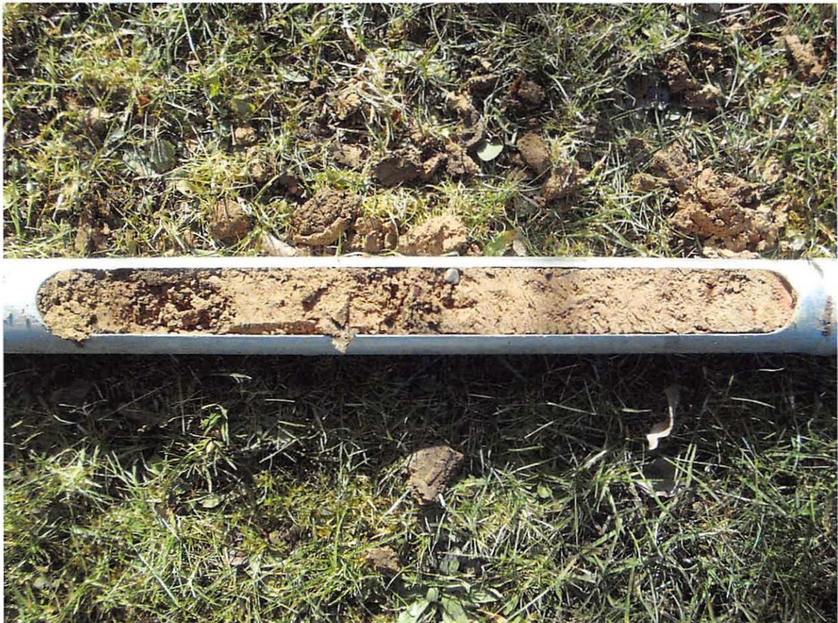
Bild 4: NW-Ecke, Schluff, stark feinsandig, bei 0,5-1,0 m.
