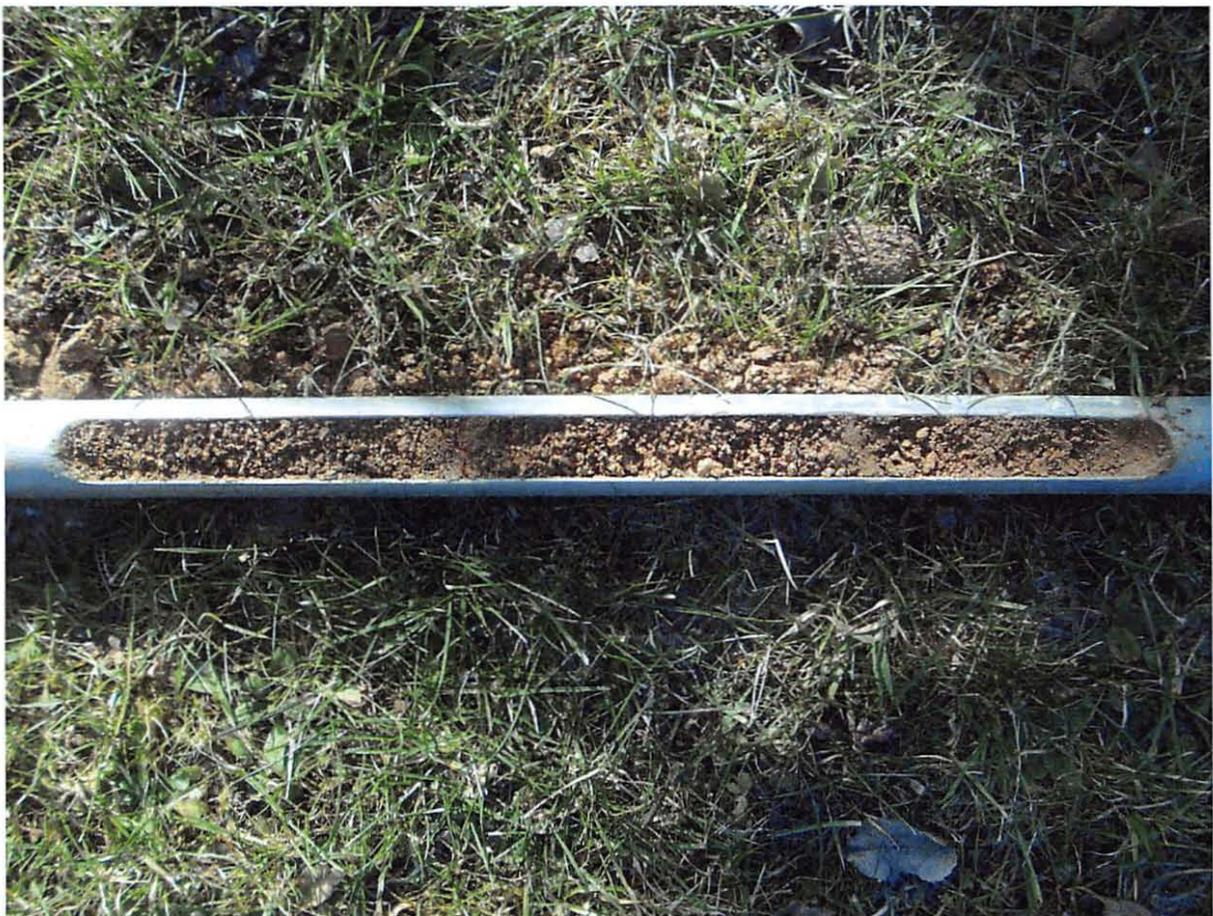
Bild 6: NW-Ecke, Bereich 2,5-3,0 m, Grobsand, feinsandig, schluffig.
