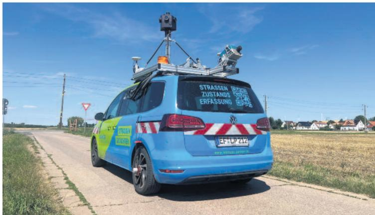
Die speziellen Messfahrzeuge der Firma LEHMANN + PARTNER GmbH aus Erfurt sind u.a. mit hochauflösenden Kameras bzw. einer Panoramakamera und verschiedenen Laserscannern ausgestattet. Mit Hilfe dieser Technologie werden alle gemeindlichen Straßen digital vermessen, somit erhalten die Verwaltungen ein realitätsgetreues Abbild ihrer Infrastruktur, einen sogenannten „Digitalen Zwilling“.
